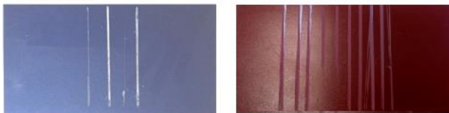
Rys. 7.2. Powłoki akrylowo-poliestrowe starzone klimatycznie w okresie dwu lat po przeprowadzonej próbie zarysowania
