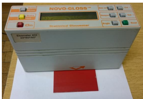
Rys. 3.12. Badanie połysku lustrzanego powłok polimerowych za pomocą połyskomierza NOVO-GLOSS Elcometer 402
