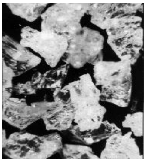
Rys. 6.9. Morfologia elektrokorundu granulowanego 99A (powiększono 20 x)
