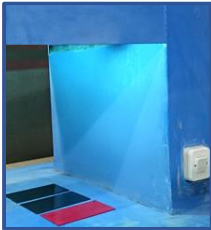
Rys. 4.14. Starzenie powłok akrylowo-poliestrowych w komorze UV
