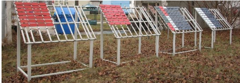
Rys. 4.1. Powłoki akrylowo-poliestrowe usytuowane na stojakach na stacji klimatycznej
