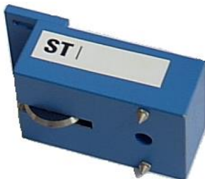
Rys. 3.5. Przyrząd do badania twardości powłok polimerowych metodą Buchholza
