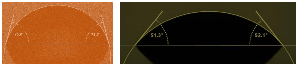
Rys. 9.6. Kąt zwilżania wodą (1) lub diiodometanem (2) powłoki akrylowo-poliestrowej czerwonej (C09) starzonej klimatycznie w okresie 18 miesięcy
