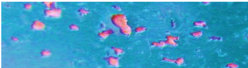
Rys. 2.19. Zdarcie powłoki lakierniczej nadwozia samochodu w obszarach jej erozyjnego zużycia pod wpływem uderzeń ziaren żwiru
