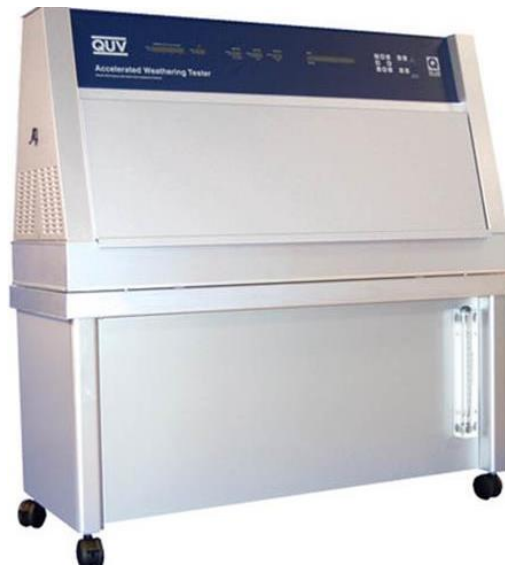
Rys. 4.23. Komora QUV do przyspieszonych badań powłok polimerowych
