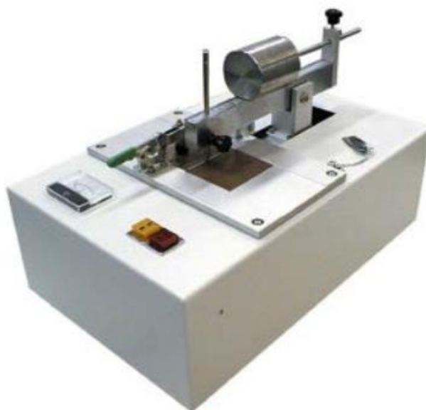
Rys. 3.11. Aparat Elcometer 3000/3 Clemen do badania odporności na zarysowanie powłok polimerowych
