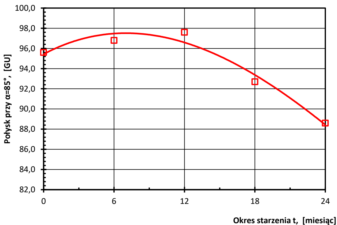
Rys. 5.75. Charakterystyka połysku powłok akrylowo-poliestrowych czerwonych starzonych klimatycznie w okresie 24 miesięcy przy kącie padania światła \alpha=85^\circ
