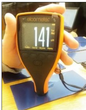
Rys. 3.3. Metoda pomiaru grubości powłok lakierniczych przyrządem Elcometer 456C
