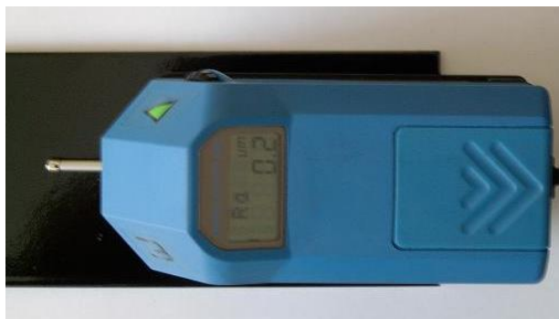
Rys. 3.6. Pomiar chropowatości powierzchni powłok polimerowych za pomocą Testera Hommel T500
