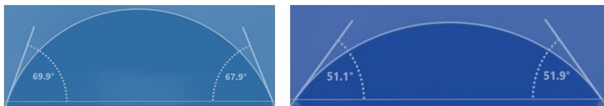
Rys. 9.9. Kąt zwilżania wodą (1) lub diiodometanem (2) powłoki akrylowo-poliestrowej (N09) niebieskiej starzonej klimatycznie w okresie 18 miesięcy
