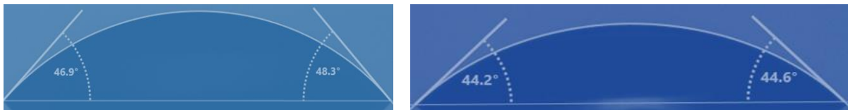
Rys. 9.10. Kąt zwilżania wodą (1) lub diiodometanem (2) powłoki akrylowo-poliestrowej (N14) niebieskiej starzonej klimatycznie w okresie 24 miesięcy
