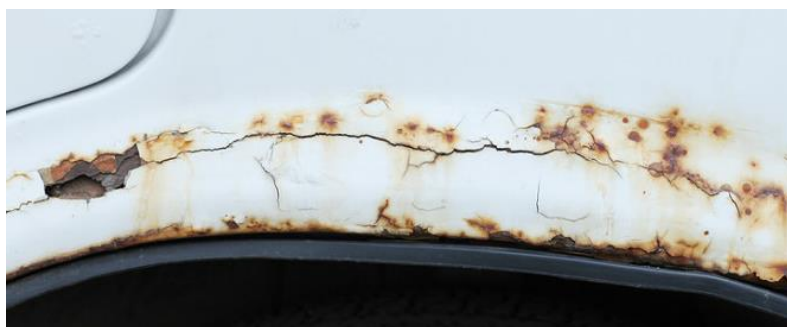
Rys. 2.4. Perforacja blachy stalowej nadwozia samochodu spowodowana korozją podpowłokową
