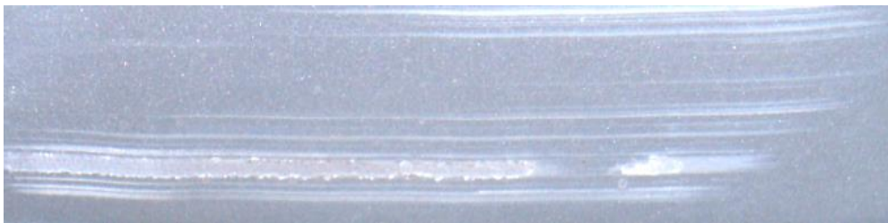
Rys. 2.18. Zarysowanie powłoki lakierniczej
