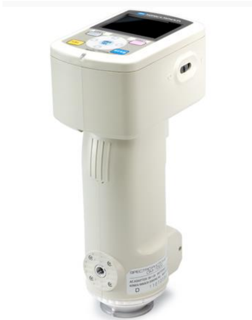
Rys. 3.14. Spektrofotometr (przenośny) CM-700d do badania barwy powłok
