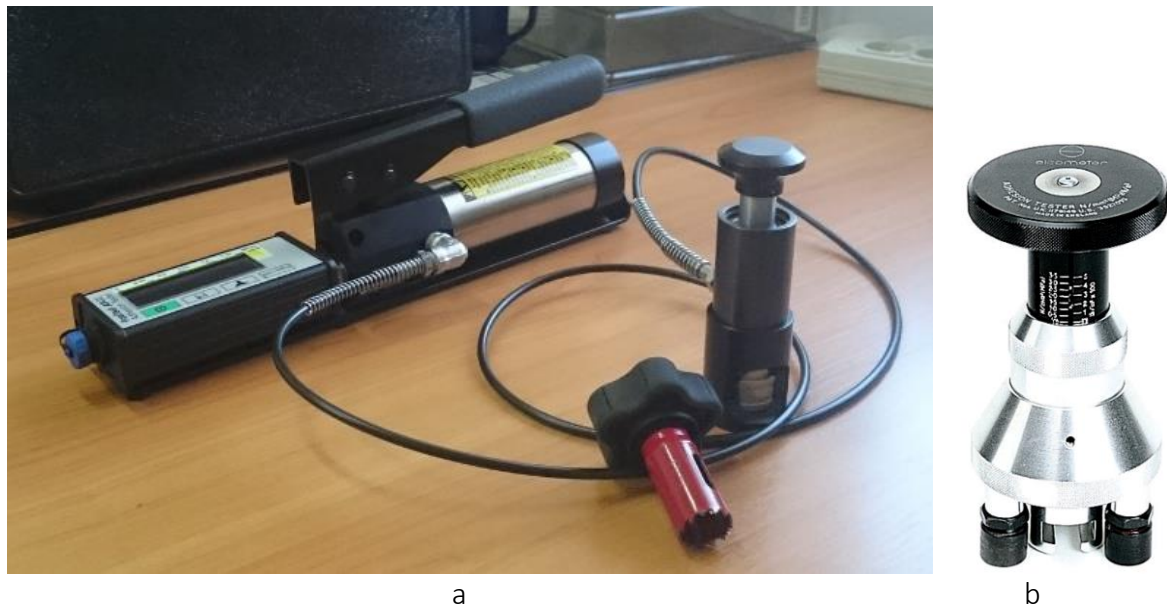
Rys. 3.10. Aparat PostiTest AT Digital do badań adhezji powłok polimerowych metodą odrywową
