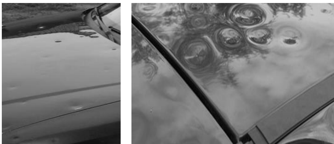
Rys. 2.21. Odkształcenie powłoki lakierniczej nadwozia samochodu w wyniku uderzeń gradu
