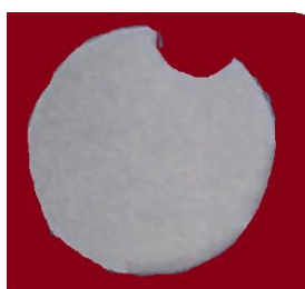
Rys. 8.3. Obraz powierzchni powłoki akrylowo-poliestrowej czerwonej, starzonej klimatycznie w okresie 24 miesięcy, po wykonanej próbie oderwania stempla od powłoki (wg PN-EN ISO 4624:2016-05)
